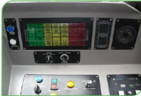
Este panel se localiza dentro de la cabina de conducción, mediante el cual el Operador del Tren Ligero verifica en que sección se accionó la palanca de emergencia (KFS), para la intervención oportuna ante una eventualidad.
